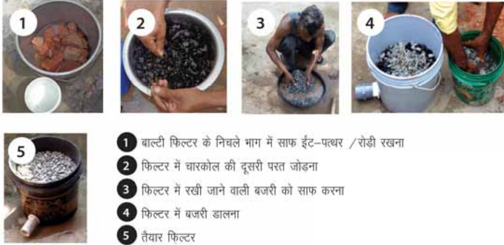
चित्र 14: चारकोल वाला फिल्टर तैयार करना
