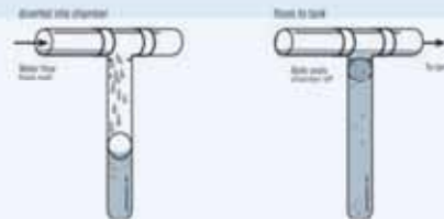
चित्र 9: फर्स्ट फ्लश जल दिशा परिवर्तक प्रणाली
